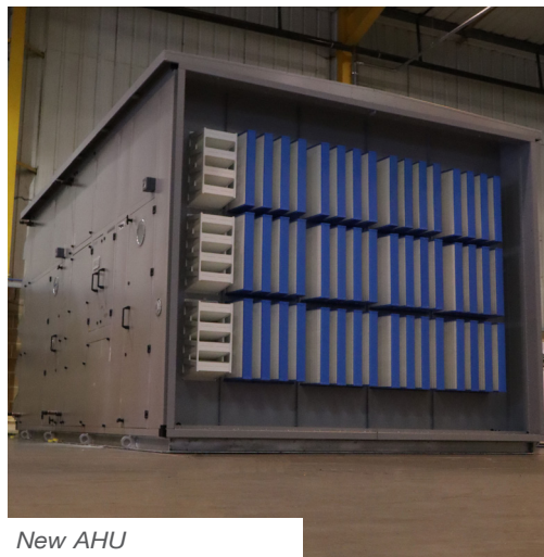
EC fan array
